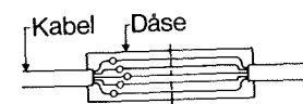
Figur 18. Samling mellem elementer med indstøbte kabler. I dåsen til venstre er vist en samling af ledningerne. I højre side er vist, hvordan dåsen kan anvendes som gennemgangsdåse.
